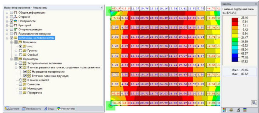
Рис. 8.4: Моменты в точках решетки  $m_x$  плиты перекрытия в проекции Z (CH1)
